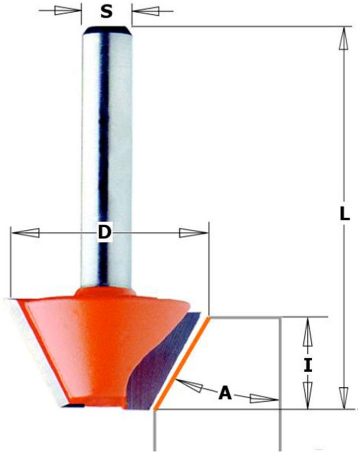
Permettant de réaliser des chanfreins de 15° à 45° selon modèle.
