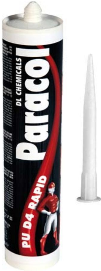
Colle polyuréthane thixotropique ayant la caractéristique remplissante et légèrement gonflante. Elle durcit par la réaction avec l'humidité dans le substrat. Les surfaces poreuses et sèches contiennent suffisamment d'humidité afin de laisser le durcissement évoluer normalement.
