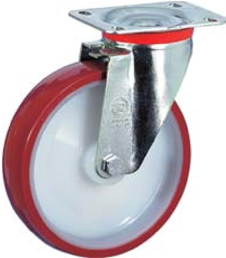
Monture constituée de platine, anneau de tenue des billes et chape en tôle d'acier inoxydable AISI 304.
