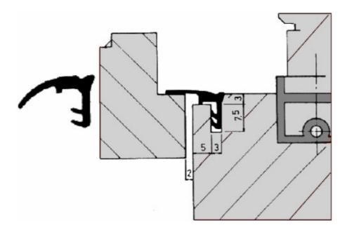
Joint de portes levantes coulissantes pour l'étanchéité des traverses supérieures.
