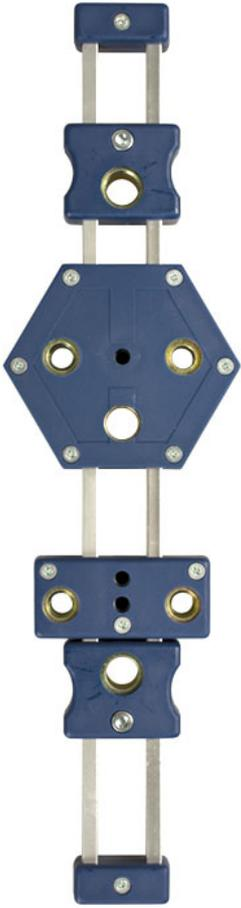
Gabarit réglable pour le montage de garnitures à rosaces, serrures avec distance d'entraxe de 55~110 mm, ainsi que pour les garnitures avec plaques monobloc HOPPE et compatibles.
